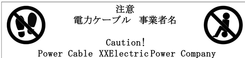
解説図 4 地上設置する管路への表示例
